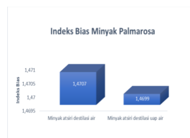
Gambar 1. Hasil uji indeks bias minyak palmarosa
