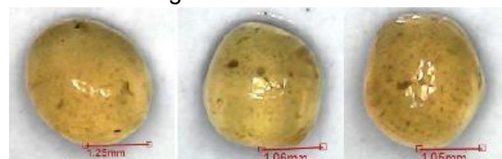
Gambar 6. Hasil uji jari-jari butiran alginat PVA dengan \text{CaSO}_4
